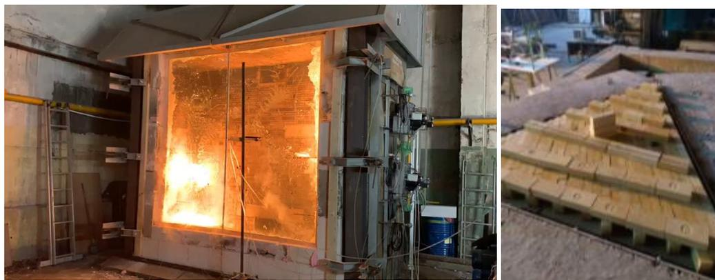
Испытания перегородки с безрамным стыком стекла
